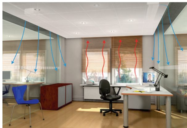
Billede 2. Celos tekniske løsning bygger på en unik patentsøgt teknik, der indebærer, at den nedkølede luft føres ned gennem en udløbsspalte i loftet langs hele væggen og derefter videre ned til gulvet.
