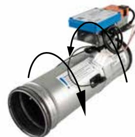
Andre forhindringer i kanalsystemet som f.eks. ventilatorer, lyddæmperbafler eller inspektionsluger e.lign. er ikke tilladt før UltraLink enheden (i luftretningen). Hvis en inspektionsluge er nødvendig, skal den placeres efter UltraLink enheden (i luftens retning) Grunden til dette er at forhindringerne skaber turbolens, som kan resultere i fejlagte volumenstrømsmålinger.
