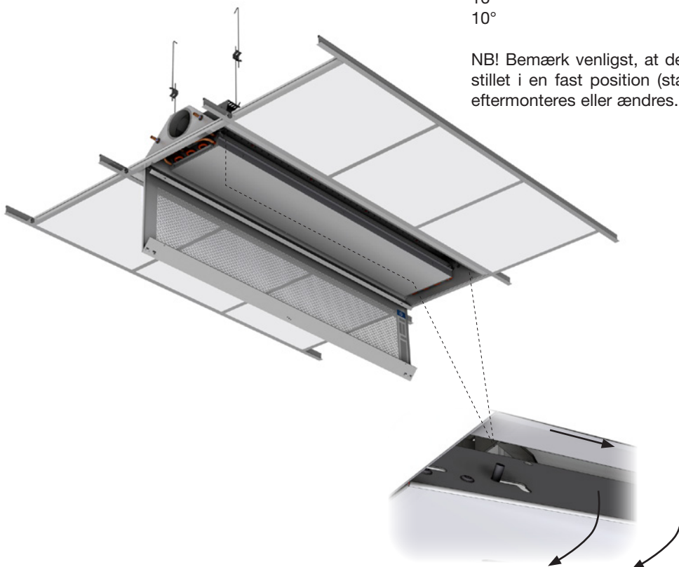
Billede 2. Når frontpladen sænkes eller fjernes, er batteriet tilgængeligt nedefra.
